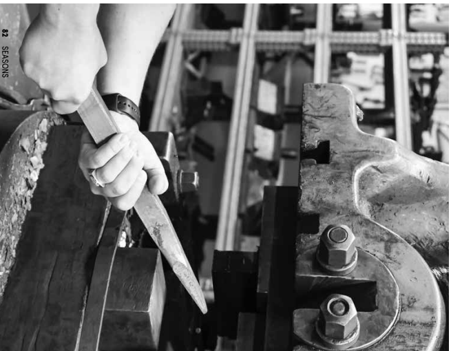
EEN MOEIE AFRONDING VAN ELK STUK GEREEDSCHAP: NA HET GLADSCHUREN EN LAKKEN WORDT HET LOGO VAN DEWIT IN HET HOUTEN HANDVAT GEBRAND
