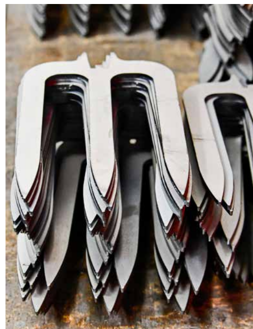
NA HET LASEREN VAN DE BASISVORMEN BEGINT HET SMEEDPROCES: HET STAAL WORDT VERHIT TOT WEL 1200 GRADEN, WAARDOOR HET WITHEET VAN KLEUR VERSCHIEFT
